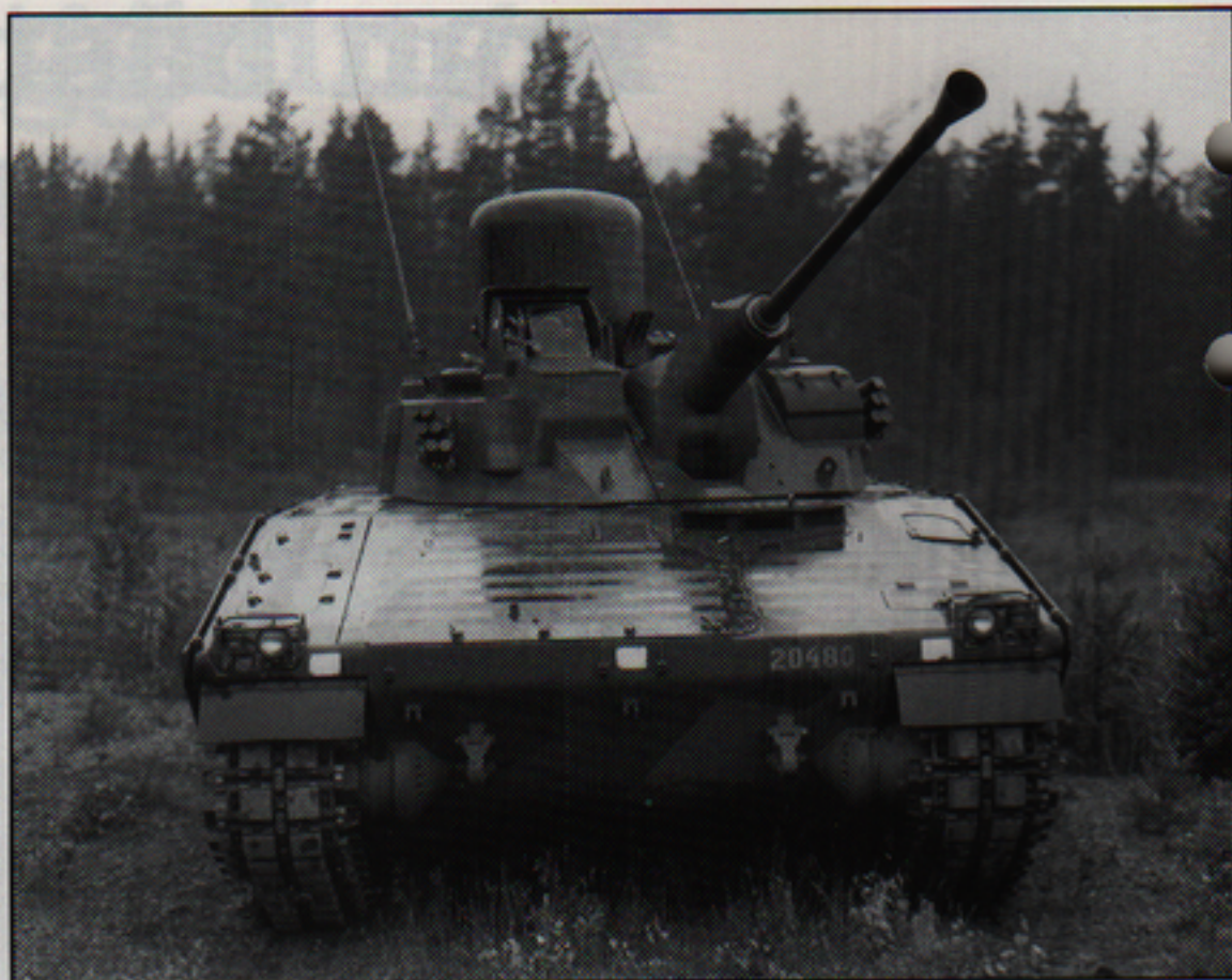
Ett av Stridsfordon 90:s specialfordon, Luftvärnskanonvagn 90 med sin spaningsradar, optiska sikte med laseravståndsmätare samt IR-sikte. Foto: Bofors AB
