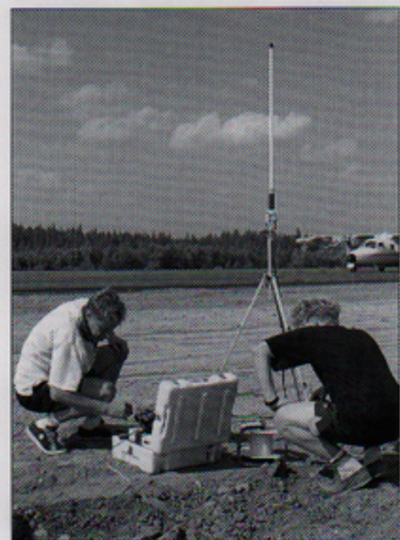
Torsten Gunnarsson och Peder Andersson vid en GPS-mottagare med korrektionsdatasändare, som kommer att få en allt större betydelse för flygplanens positionsangivelser. Den kan då ersätta mätningarna med teodoliten när landningshjälpmedlen ska kontrolleras.
