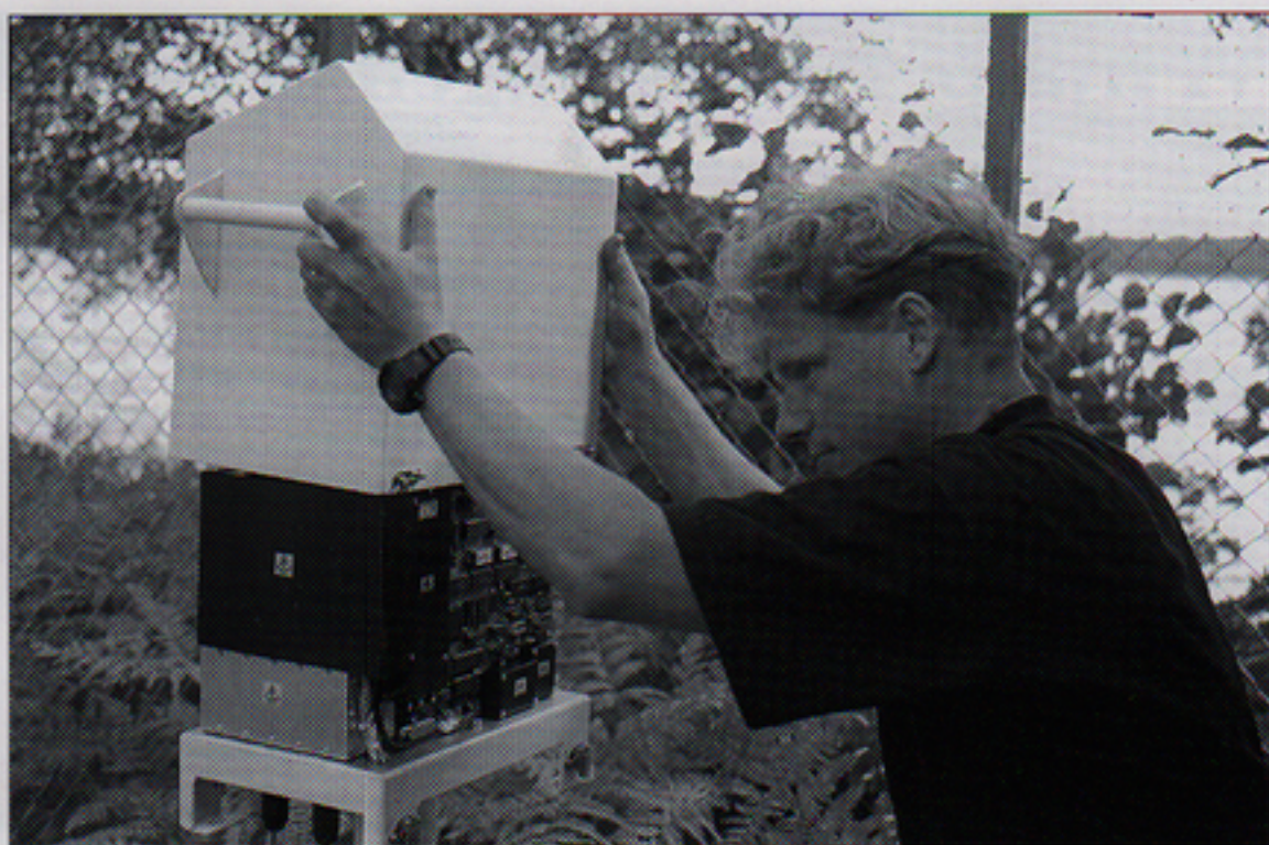
Peder Andersson tittar till lasermolnhöjdmätaren, som står naturskönt intill Helgasjön, och som betjänar Växjö Flygplats trafikledare med information om molnhöjd, molnskiktningar och fuktighetsgrad i molnen. Uppgifter som är värdefulla för piloterna.
