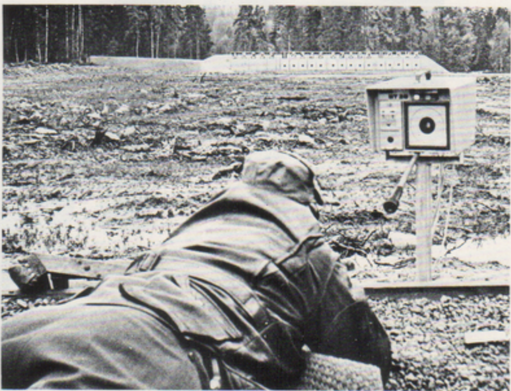
Anläggningen blir enklare och billigare när man använder elektronisk markering. Här har man dock — för säkerhets skull — byggt de fem vänstra tavlorna för manuell markering.
