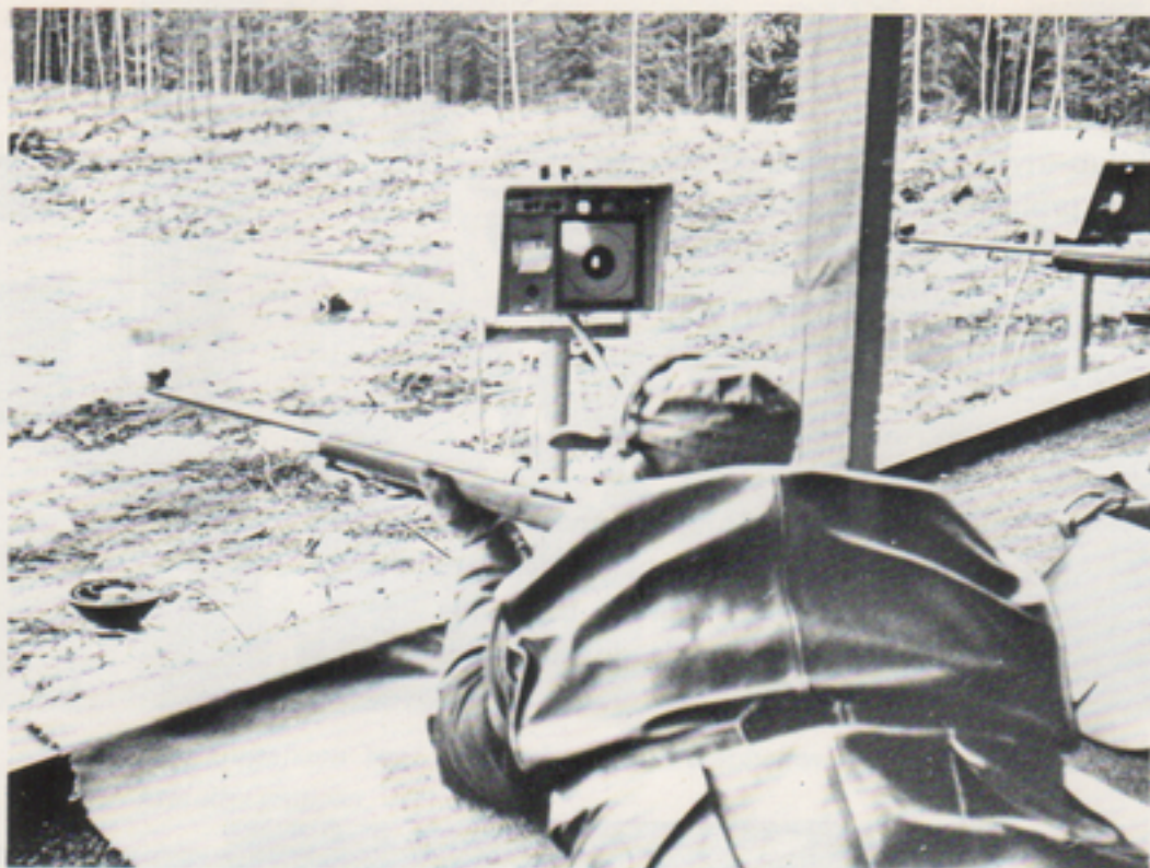
»8 — högt vänster». Skytten får resultatet omedelbart och behöver inte vänta på att markören skall hitta kulhålet. Mikrofonen framför skytten svarar för att bara de egna skotten markeras.
