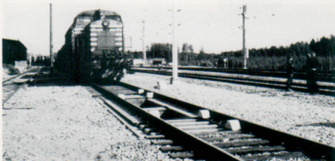
Trapper vagnvåg för automatisk vägning. Bilden från Vainikkala, Finland.
